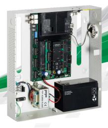
AC-525U IS A HIGHLY ADVANCED NETWORKED CONTROL PANEL THAT OFFERS UNIFIED ACCESS CONTROL AND DIGITAL VIDEO RECORDING AT MPEG-4 FORMAT AND WEB SERVER COMPONENTS.
